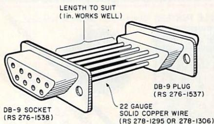
THE WIRE IS A SNUG FIT INTO THE SOLDER CUPS ON THE CONNECTORS. I THEN USED LIQUID RUBBER (AVAILABLE FROM PLASTIC SHOPS) TO SURROUND THE WIRES CONNECTING THE SOCKET AND PLUG.
